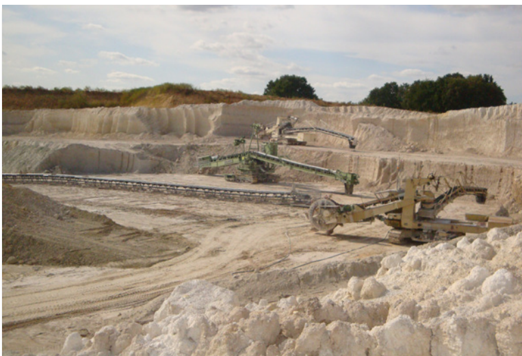
M2: Kaolinabbau im Tagebau
